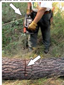
Execução do traço com a motosserra (*)
