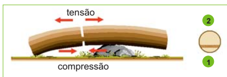
Forças de tensão no lado superior do tronco
