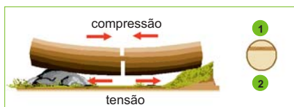
Forças de tensão no lado inferior do tronco
