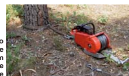
Fixação do equipamento de tração com estropo à árvore de suporte
