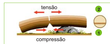
Troncos de grandes dimensões: primeiro corte em forma de cunha
